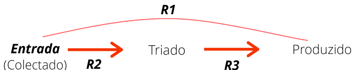
Figura 23- Esquema dos rácios de reciclagem ao longo do processo produtivo
